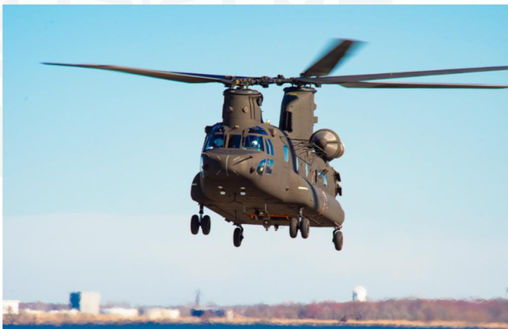
Amélioration du CH-47D, sortie en 2006. Parmi ces modifications, on retrouve les nouveaux moteurs Honeywell de 4,868 chevaux, la refonte complète de l'avionique et une amélioration de la structure visant à améliorer l'aérodynamisme et diminuer les vibrations.
